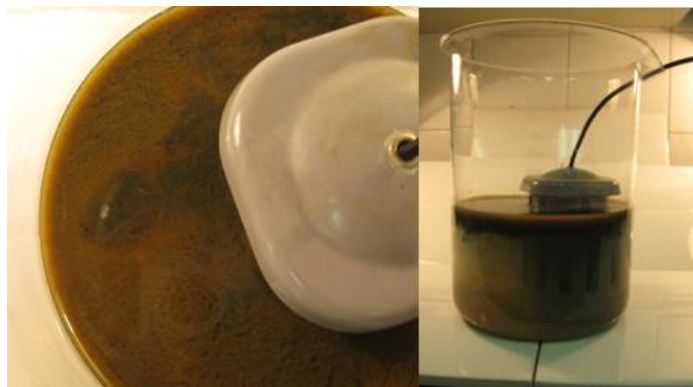
4.6. ábra Az elektrolízis során keletkezett csapadék színe felülnézetből, illetve elektrolízis közben. Látszik, hogy a csapadék színe nem egységes.
