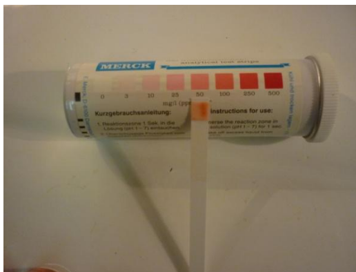
3.13. ábra , \text{Fe}^{2+} gyorseszteszt színe, vas (II) az előírtaknak megfelelő sókoncentráció kb. tizennyolcszorosával készített oldat elektrolízise után (30 perc)
